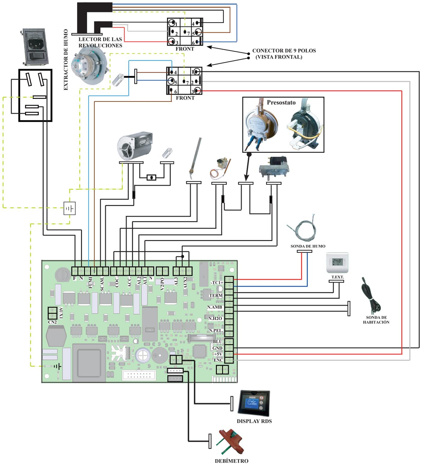
**Esquema eléctrico estufas con canalización individual**
