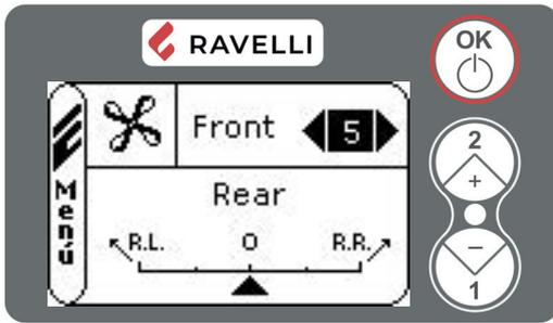
La parte superior de la pantalla permite modificar la potencia de la ventilación frontal. El valor que se puede configurar va de 0 (ventilación apagada) a 5. Con la configuración en A (auto), la potencia de los ventiladores se ajusta a la potencia de la estufa.
