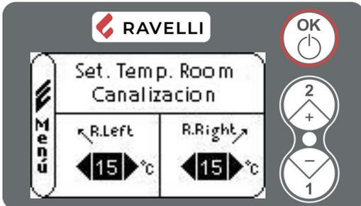
Confirme con la tecla OK 2 veces hasta que aparezca la pantalla para la configuración del set de temperatura ambiente de las dos habitaciones canalizadas. Para pasar de la opción «R. left» (canalización izquierda) a «R. right» (canalización derecha), pulse la tecla OK.
