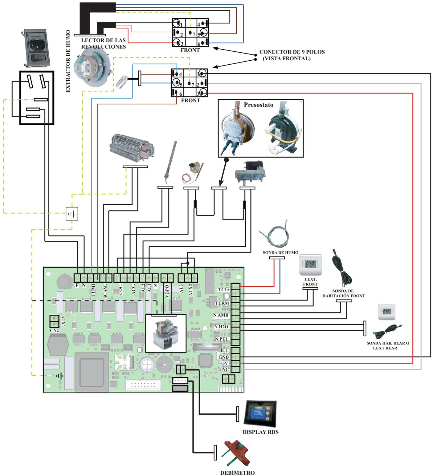
**Esquema eléctrico estufas con canalización doble**
